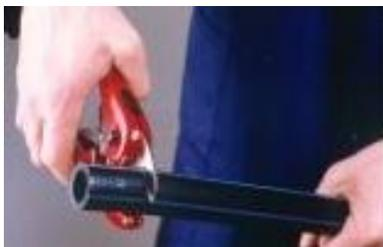
2. Очистить края от заусениц, закруглить (скосить) кромки конца трубы. Наружная поверхность трубы должна быть гладкой и не иметь дефектов по всей длине, вставляемой в тело фитинга. Зачистка производится специальным инструментом или при помощи обычного канцелярского ножа.
