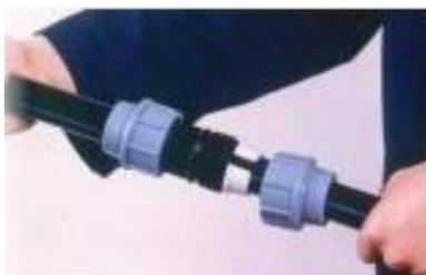
5. Закрутить обжимную гайку рукой (диаметром до 40 мм включительно) или при помощи специального или цепного ключа (при диаметре свыше 40 мм). Герметичность соединения достигается благодаря деформации уплотнительного кольца, которое плотно прижимается к внутренней поверхности корпуса и наружной поверхности ПЭ трубы по мере закручивания крышки-гайки.
